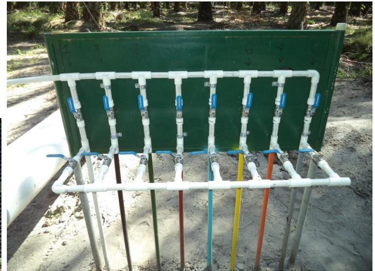
Se construye un tablero de operación donde cada turno va a tener dos válvulas de operación.
