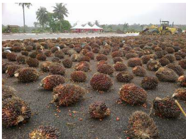
Izquierda: Evaluación de racimos en la plataforma de la extractora. El proceso es muy confiable pero causa muchos daños al racimo, incrementando el contenido de AGL. Derecha: sistema de cuerda con nudos en la tolva de la planta.
