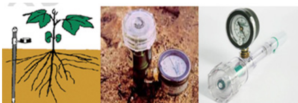
Figura 7. Establecimiento de tensiómetros en campo.
